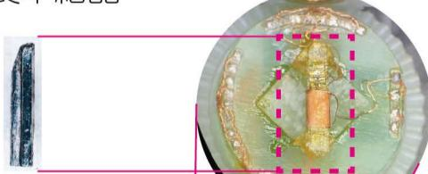
試料を磁場中で精密に回転させて測定
