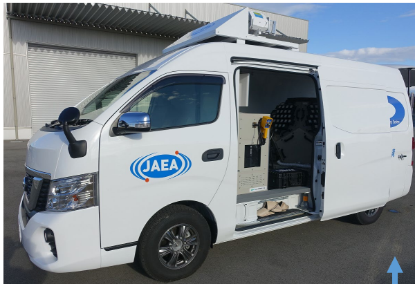
開発した放射線イメージングシステム車 「iRIS-V」 integrated Radiation Imaging System-Vehicle
