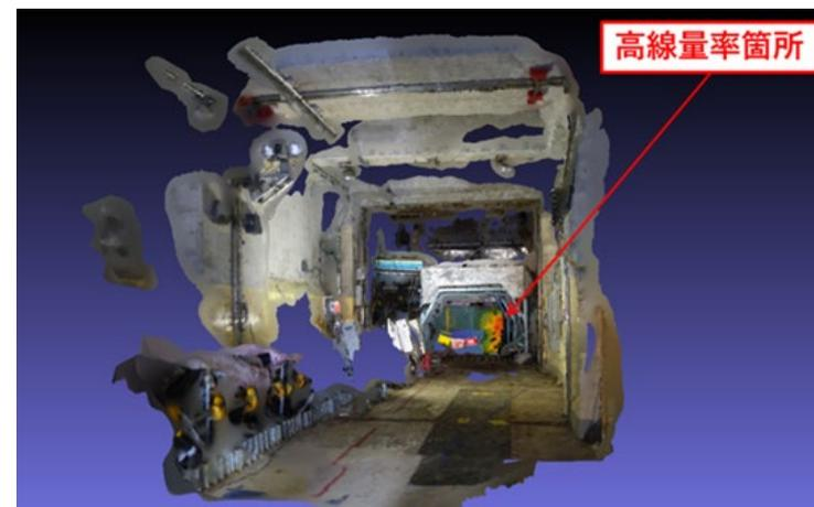
測定した放射線の分布に基づき、作業現場を3次元モデル化。作業エリアのホットスポットを可視化した。
