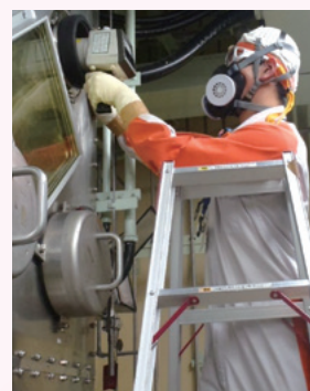
汚染状況調査（線量率測定）
