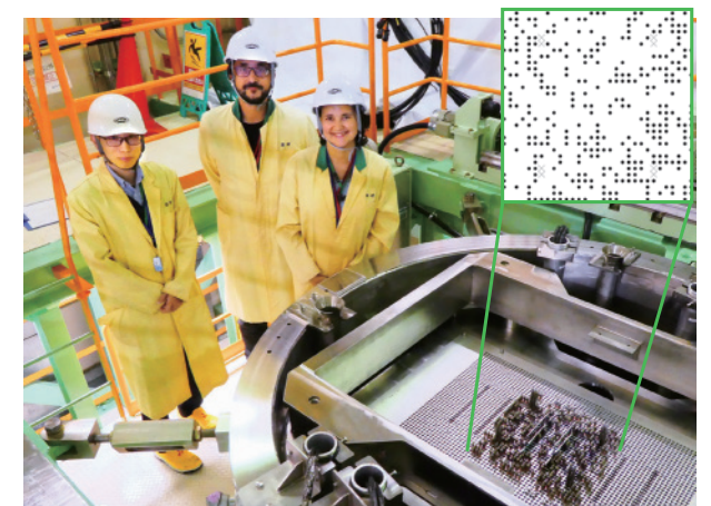
STACY更新炉(乱雑な燃料棒配置)の実験で フランス研究機関IRSN(現ASNR)と協力 右上の炉心構成図: ●印:燃料棒 ×印:安全板ガイドピン
