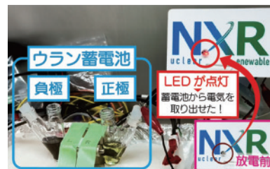
ウラン蓄電池の放電試験の様子
