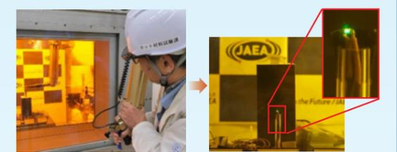
遠隔操作でAm封入ピンを挿入 熱電変換デバイスの起電力でLED発光
