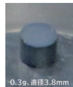
アメリシウム-241の沈殿回収（左）と焼結後のペレット（右）
