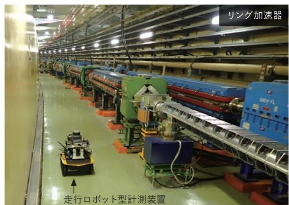
走行ロボットを用いた測定試験
