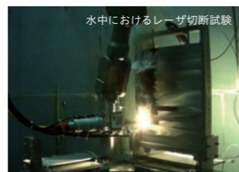
「ふげん」遠隔レーザー切断技術の開発
