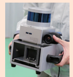
廃炉現場の汚染分布を3次元マップで「見える化」する「IRIS」
