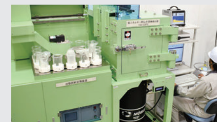
ワークショップに設置した低エネルギー用Ge半導体検出器
