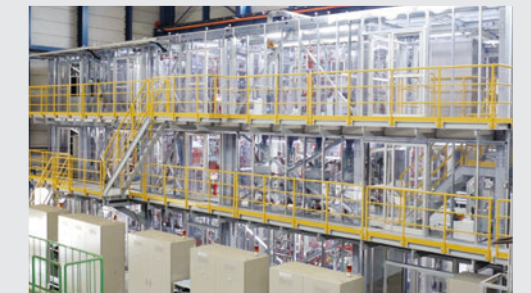
150時間の水素製造に成功した試験装置 (水素製造量: ~0.1m³/h-H₂, W18.5xD5xH8.1 (m))
