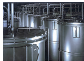
ウラン濃縮原型プラントDOP-2遠心分離機
