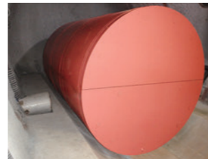
【幌延】坑道構置き模擬PEM ® の設置 ※ Prefabricated Engineered barrier system Moduleの略。鋼製の容器の中に、人工バリアであるオーバーバックや緩衝材を設置し、一体化したもの。
