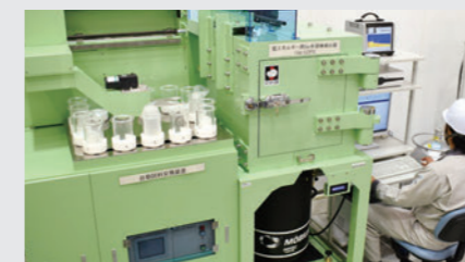
ワークショップに設置した低エネルギー用Ge半導体検出器
