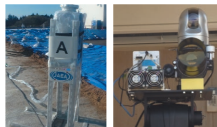
ダストサンプラ 小型偏光ライダー 人体に無害なレーザー光を利用して粉塵の分布を測定する「ライダー」という技術とダストサンプラを組み合わせることで、工事等で発生した粉塵の飛散状況と空気中の放射能濃度を把握。小型偏光ライダーは、遠隔操作による自動計測が可能です。
