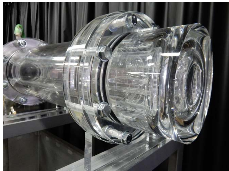
TEF-Tターゲット内の流れ場可視化のため の試験装置
