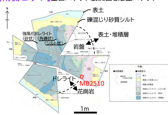
花崗岩/ドレライトの貫入境界の代表傾斜: N37° E26° E 貫入後の顕著な断層運動を示唆する構造は認められない。
