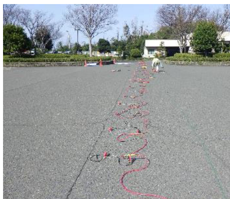
探査測線配置事例
