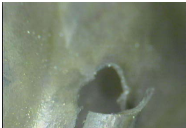
直径約5mmの穴を確認 拡大図(撮影日:2月6日)
