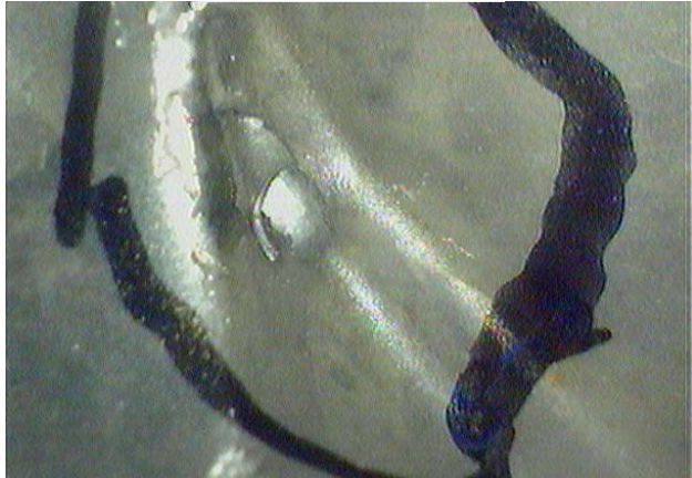
直径約5mmの穴を確認 拡大図(撮影日:2月6日)
