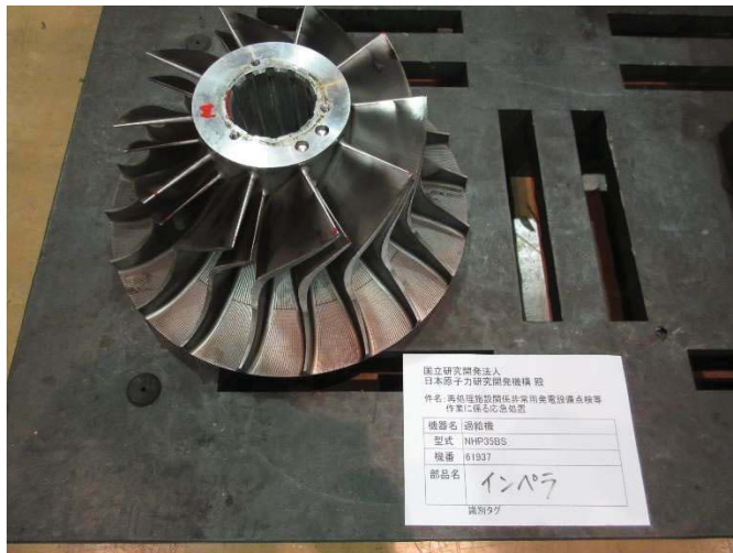
写真 7-1 インペラ (全体)
