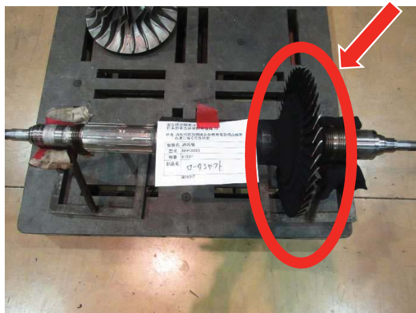
写真 1-1 タービンプレード (全体)
