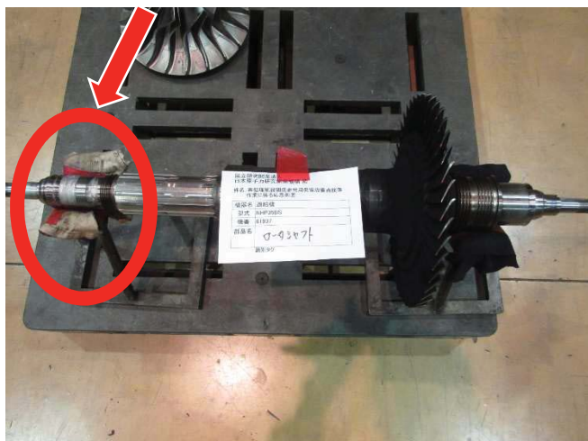
写真 8-1 ロータシャフト (全体)
