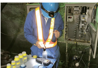
深部地下での 地下水データ取得（幌延）
