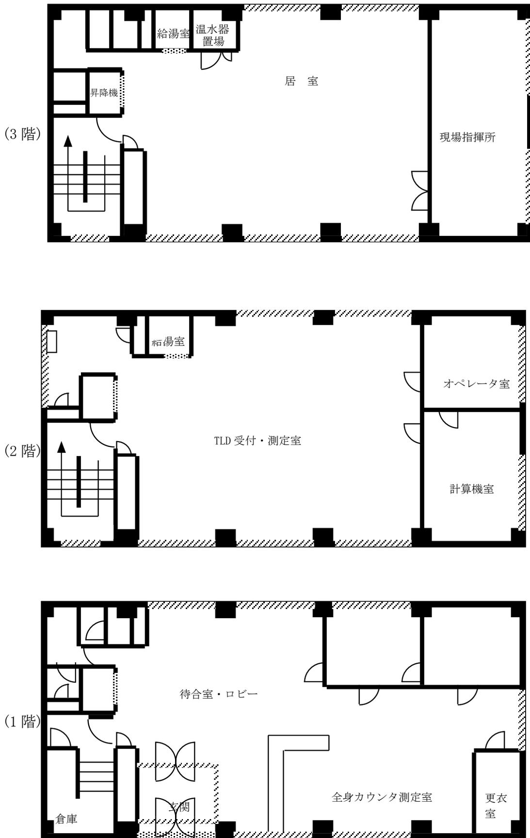
図1 個人被ばく管理棟 平面図
