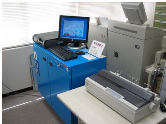
線量計読取装置 (TLD 自動読取装置)
