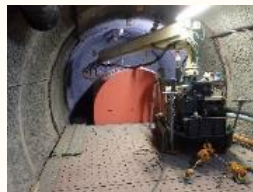
幌延の地下坑道での模擬廃棄体を用いた搬送定置試験の様子
