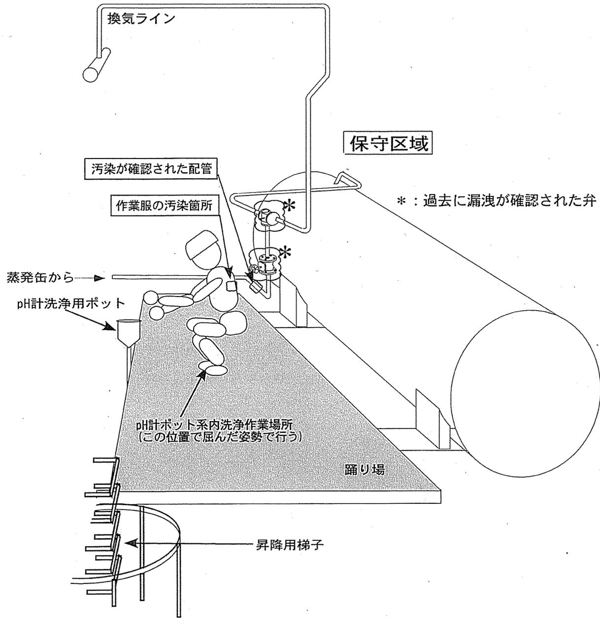
図 汚染を確認した配管周りの概要図
