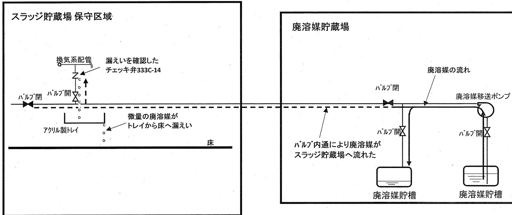
図-1 廃溶媒漏えい時の状況
