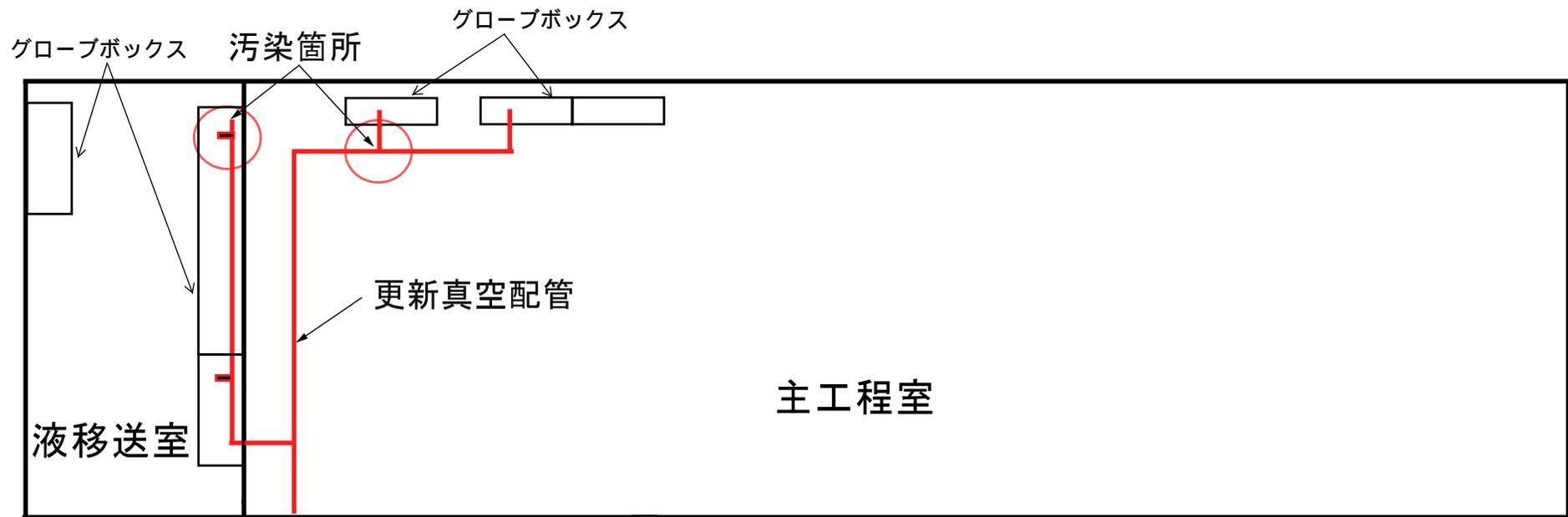
図一1 真空配管汚染箇所
