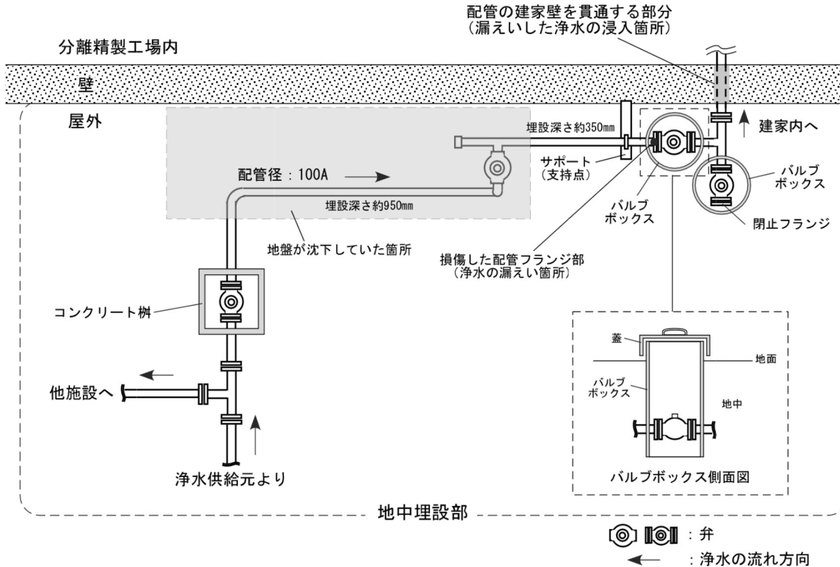
別図 浄水（工業用水）の漏えい箇所 概要図（平面図）
