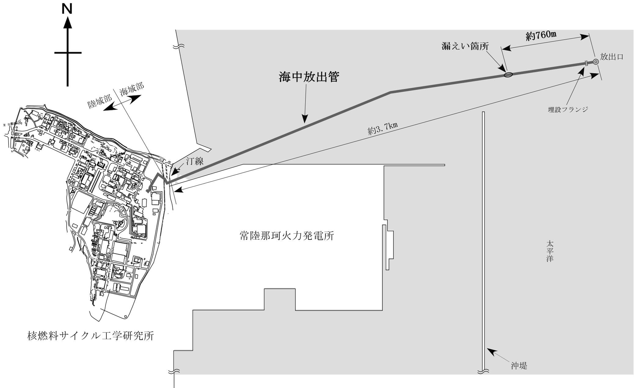
図 - 2 海中放出管経路概要図 (漏えい箇所)
