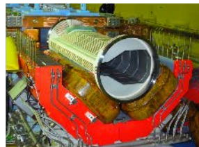
入射部四極電磁石用セラミック製ビームパイプ
