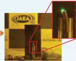
熱電変換デバイスの起電力でLED発光
