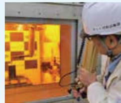
遠隔操作でAm封入ピンを挿入
