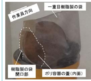
樹脂製の袋の破裂状況
