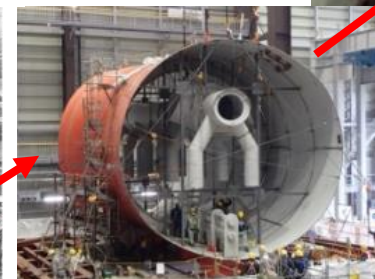
実物大の寸法の機器を1/8 切り出した試験体 (IRIDによる開発プロジェクト)
