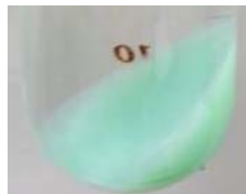
沈殿除染でのCs捕捉剤 (公開文献に基づき原子力機構が試合成したもの)
