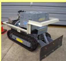
JAEA-1号 (屋内瓦礫除去・観察ロボット)
