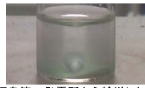
福島第一発電所から輸送した滞留水からの沈殿（サイクル研 OPF グローブボックスにて）
