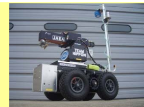
JAEA-3号 (屋内観察・γ線可視化ロボット)
