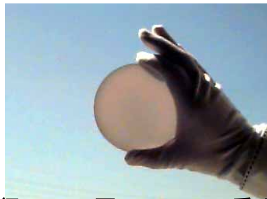
直径10cm、厚み2~3mm、重さ300カラットの人工ダイヤ
