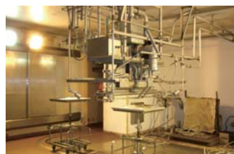
電子加速器 高崎量子応用研究所では、2MeV、30mAの加速器を所有しており、加速管内で加速された電子は電磁石によって走査され電子線となる。
