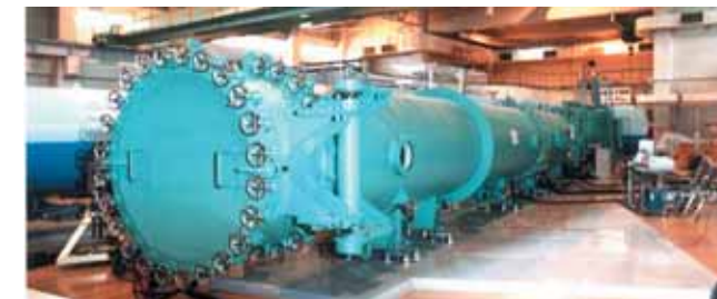
図1 SANS-J-IIの外観(2次元検出器を納める真空容器部分)
