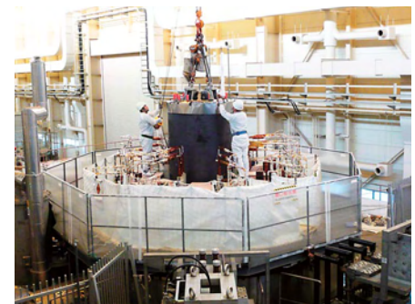
PFインサート・コイルを超伝導コイル試験装置へ組み込む様子
