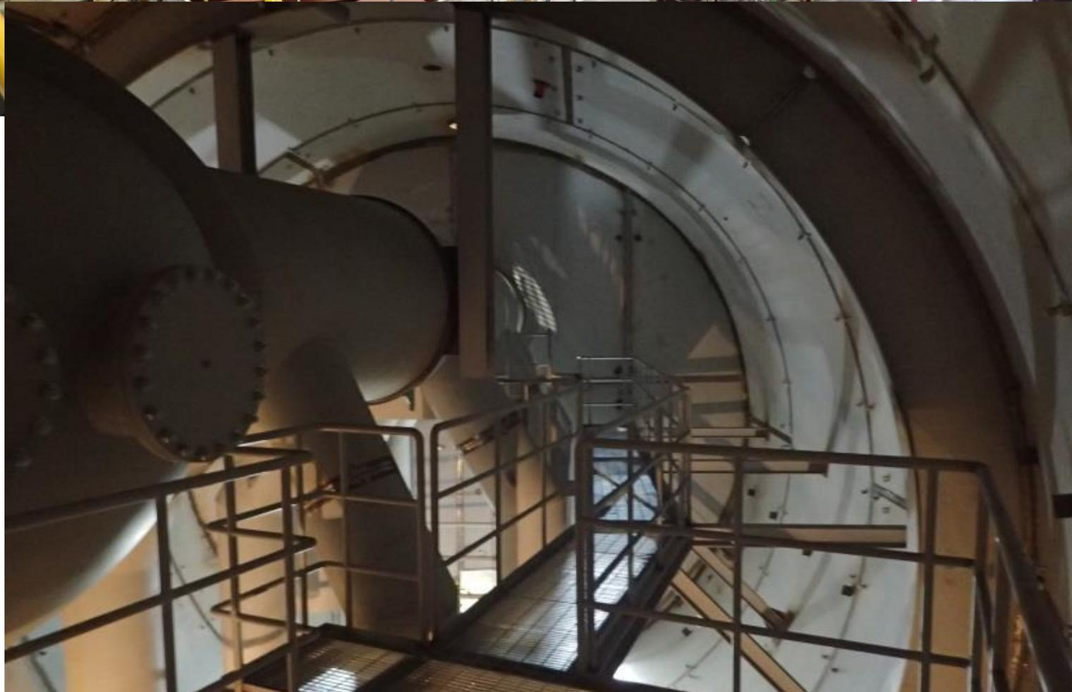
国際廃炉研究開発機構 (IRID) は、原子炉格納容器下部を模擬した実規模試験体を使って、漏えい箇所の補修や止水技術の実証試験を行っています。
