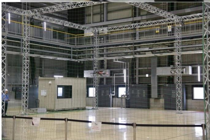
ドローンなどのロボットの動作を16台の高速度カメラで撮影しデジタルデータにすることで、動作を定量的に解析することができます。
