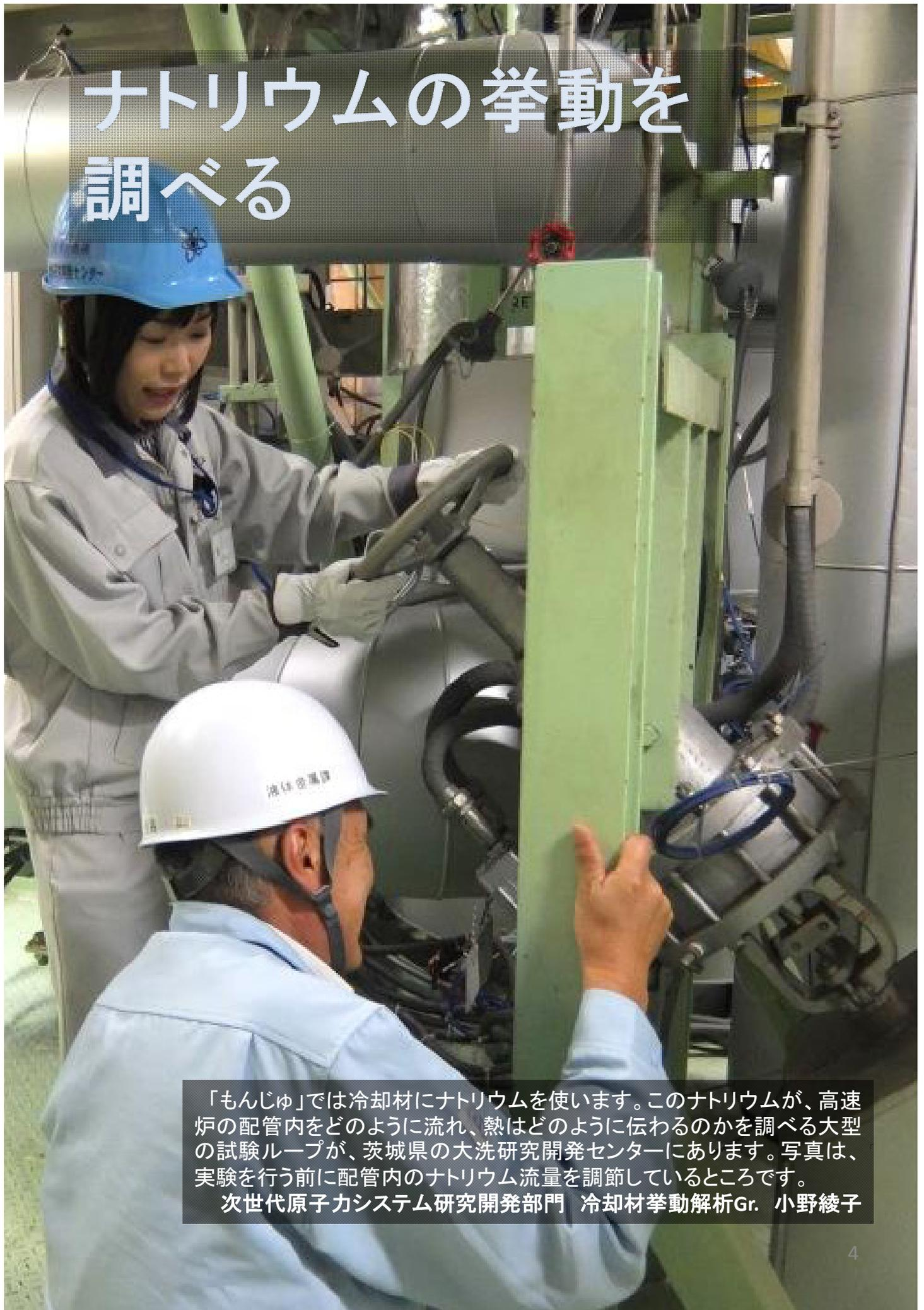
「もんじゅ」では冷却材にナトリウムを使います。このナトリウムが、高速炉の配管内をどのように流れ、熱はどのように伝わるのかを調べる大型の試験ループが、茨城県の大洗研究開発センターにあります。写真は、実験を行う前に配管内のナトリウム流量を調節しているところです。
