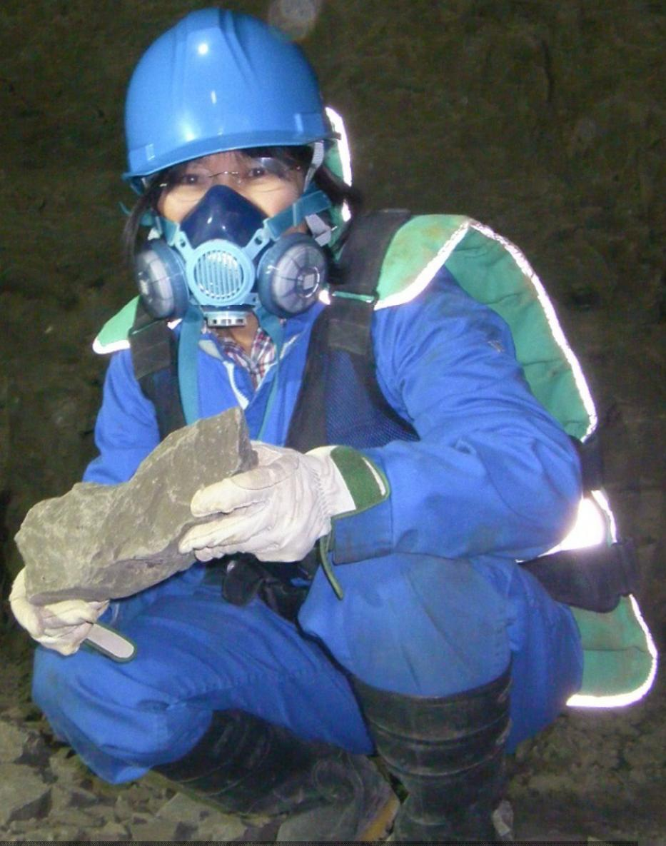
幌延深地層研究センターの地下350mにある調査坑道で、岩石中にどんな有機物や微生物が含まれているかを分析するために、試料を採取しているところです。後方は切羽と呼ばれる掘削面です。
