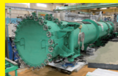
杉田氏が装置を担当する、 研究用原子炉JRR-3の 中性子小角散乱装置。
