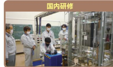
沸騰熱伝達実習では伝熱面が蒸気で覆われることにより高温になるバーンアウトが見られる。
