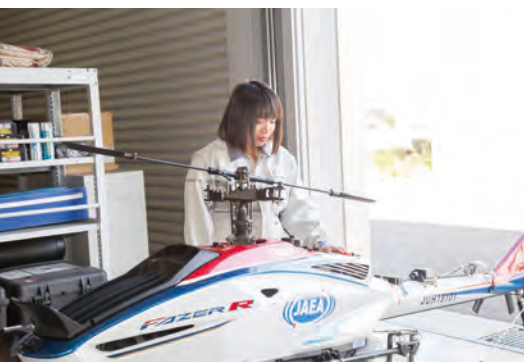
放射線モニタリングに使用している無人ヘリコプター。プログラミングをしたとおりのルート飛ばすことができる。
