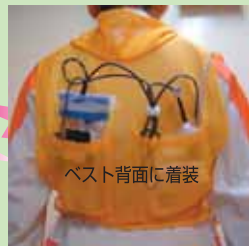
データ記録装置や電源はベストの背中に装着する。
