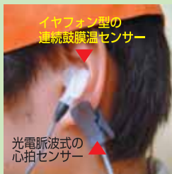
目に鼓膜温度センサーと心拍センサーを取り付ける
