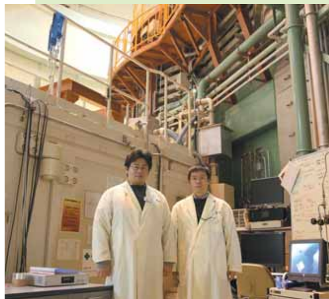
●中性子イメージング装置は大きな箱形の装置(後ろクリーム色)。右下のモニターに映像が写る。写真中央右の緑色の部分が中性子発生源となる原子炉。
