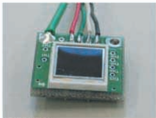
●PINフォトダイオード 開発された簡易放射線メータで実際に使用されているPINフォトダイオード。狭く長くなる部分に放射線や光を感知する部分で大きさはおよそ1平方センチメートル。
