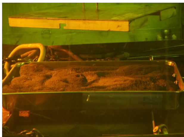
専用トレイによるせん断粉末の 保管状態(取出し前)
