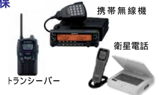
緊急時に使用する通信機器 (全て電池・充電式)
