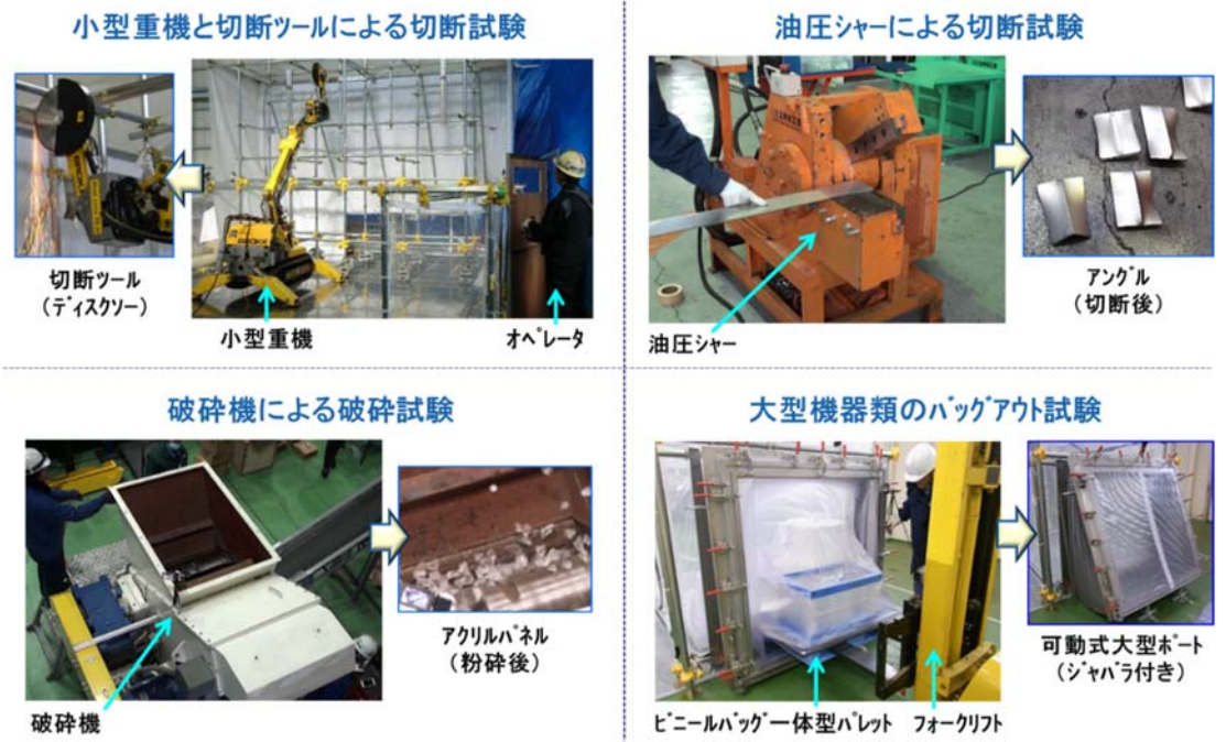
A-SDS の要素技術開発に係るモックアップ試験 (一例)
