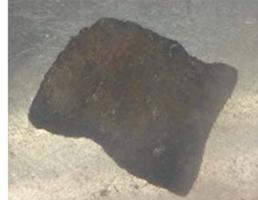
スプレー塔に設置した試験片SUS304鋼
