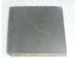
一次セラミックフィルタに設置した試験片SUS304鋼
