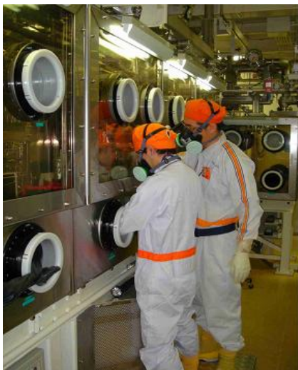
U/Pu/Amを使った電解精製実験の様子 (電力中央研究所との共同研究)
