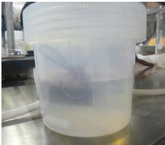
セメント試験片の浸漬状況
