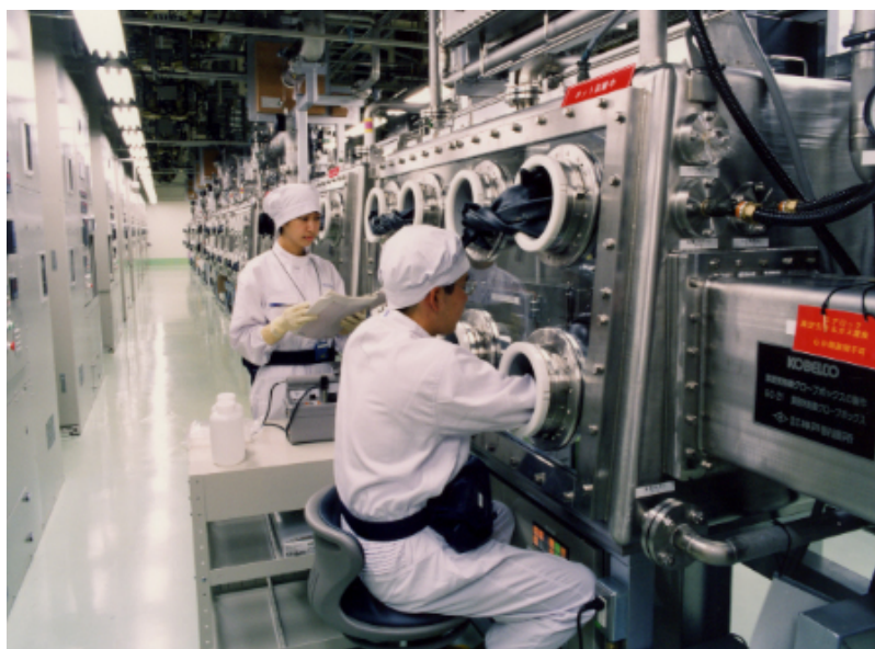
図 1 酸素の少ない環境を模擬した装置を用いた実験の様子
