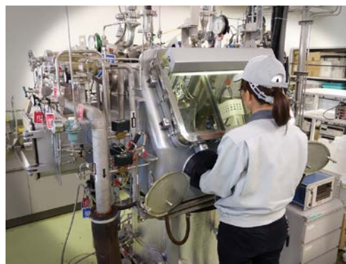
図 1. 酸素のほとんどない環境を再現したグローブボックスを使用した試験の様子
