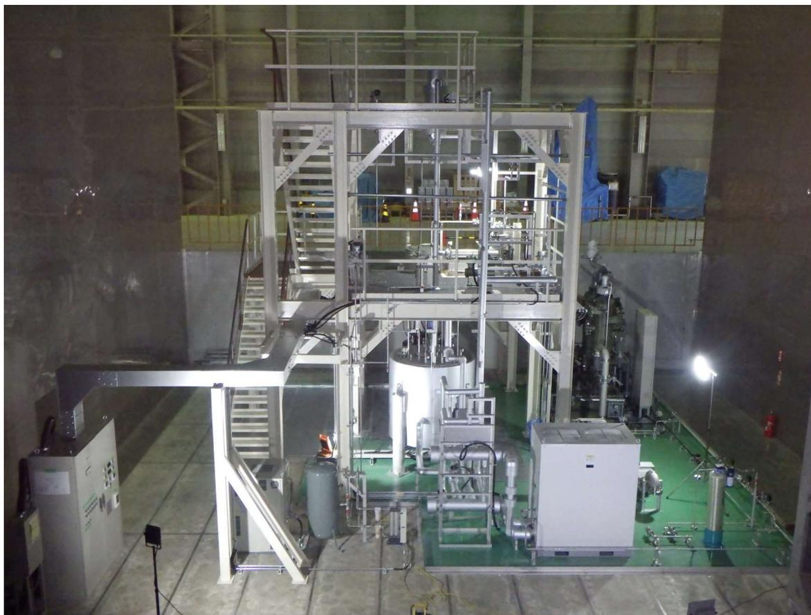
硝酸根分解設備の実証プラント規模試験装置
